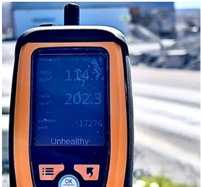
Figur 4 Måling gjort ved innkjørselen til VIMAS/fra gangveien som viser PM2.5 på 114,7 og PM10 på 202,3 \mu\text{g}/\text{m}^3 24.04.2026 ca. kl 14:30.
